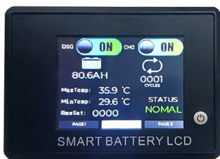
Affichage pour montage dans un tableau de bord afin de lire en temps réel l'état de la batterie
